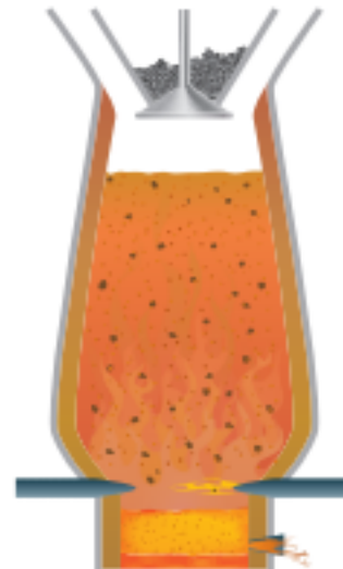
ب) گرما دادن مخلوط سنگ آهن، کربن و سنگ آهک در کوره
